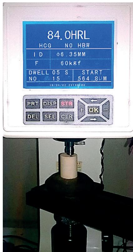
Figura 2. Evaluación de la dureza (Durómetro Universal Identec)
