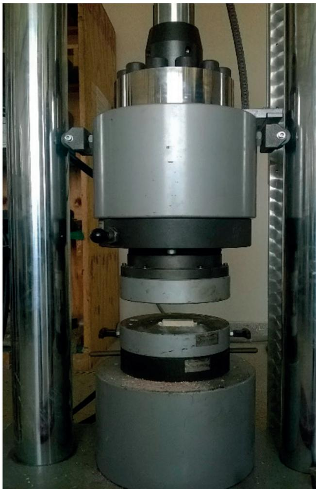
**Figura 4.** Evaluación de Resistencia a Compresión (Máquina de Ensayo Universal Instron 8801)
