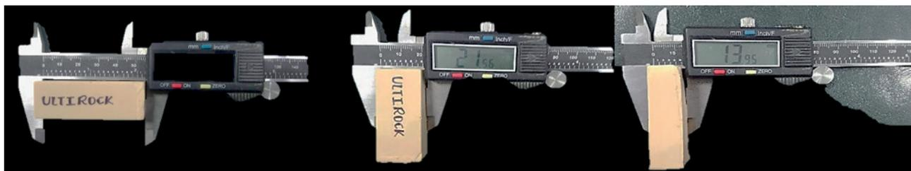
**Figura 3.** Evaluación de la Estabilidad Dimensional (Vernier digital NEIKO Stainless HARDEND)
