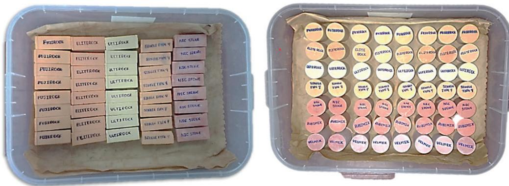
Figura 1. Especímenes de yeso de forma cuadrangular y cilíndrica rotulados.
