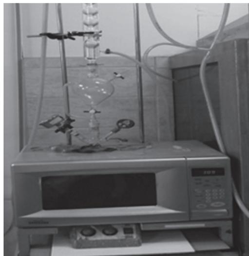
Figura 5: Ilustración del sistema de polimerización del PLA.
