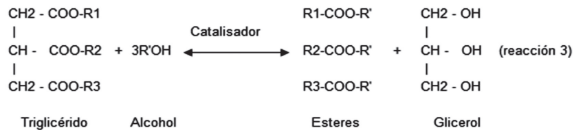
Figura 2. Reacción de transesterificación (elaboración propia).
