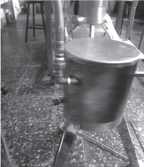
Figura 10. Tanque que soporta el serpentín.
