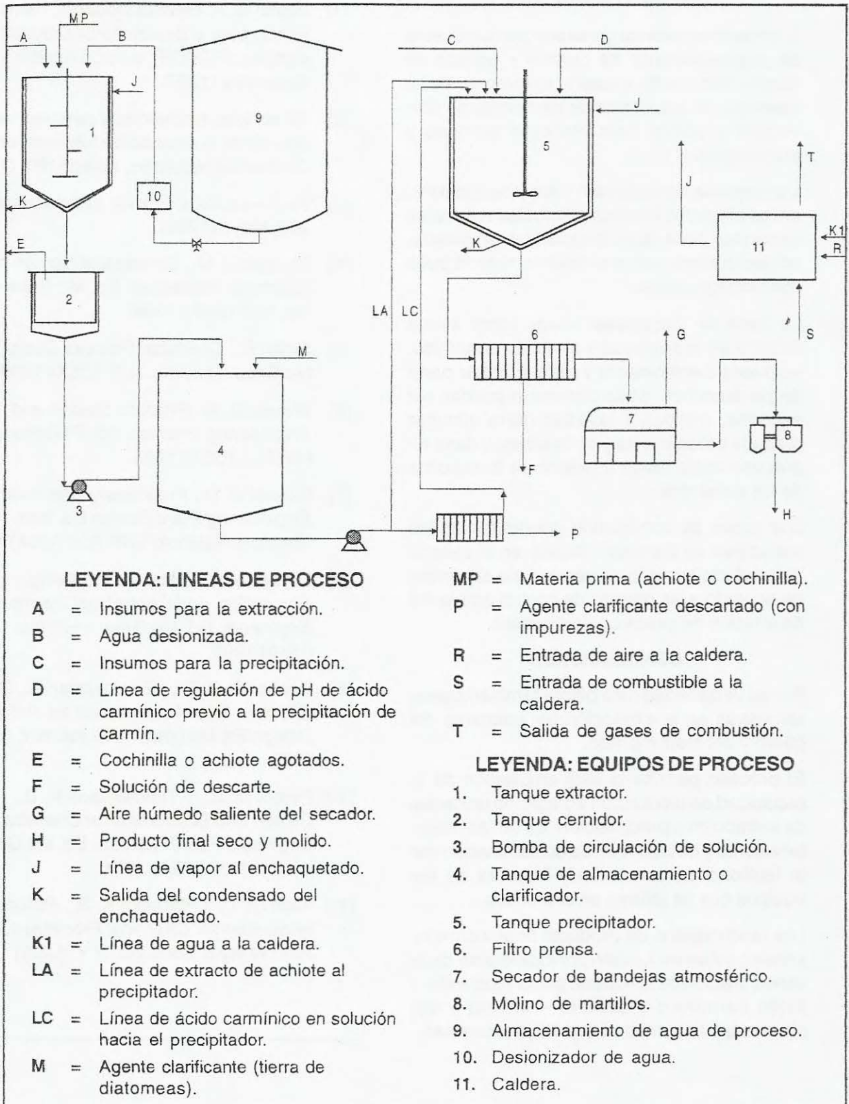
Figura 7. Distribución de equipos y líneas de proceso en la fabricación de carmín y annato.
