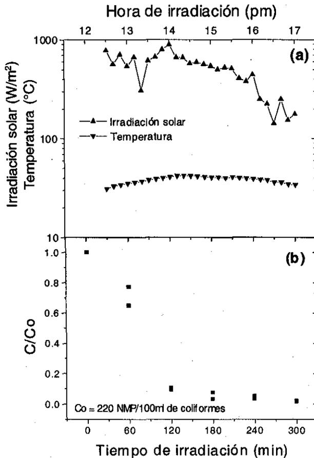
Figura N.º 1. (a) Irradiación solar ( $W/m^2$ ) y Temperatura de una muestra ( $^{\circ}C$ ), durante un experimento típico de descontaminación de agua. (b) Concentración de coliformes normalizada con respecto a la concentración inicial  $C_0$ , durante un experimento típico de descontaminación de agua
