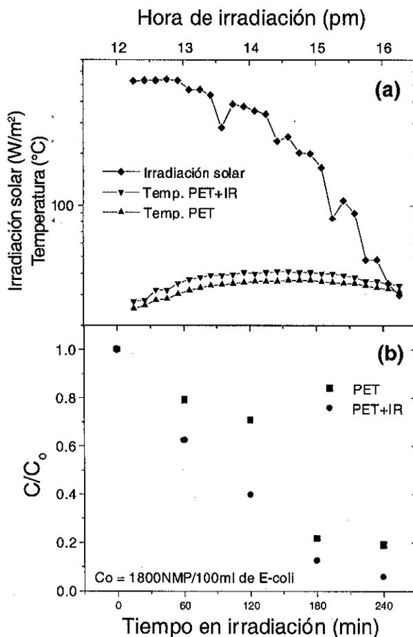
Figura N.º 3. (a) Irradiación solar (W/m2) y temperatura durante un experimento típico de descontaminación de agua llevado a cabo con: (▲) botellas transparente y (▼) botellas pintadas externamente de negro en su mitad inferior. (b) Concentración de E-coli normalizada respecto de la concentración inicial  $C_0$ , durante un experimento típico de descontaminación de agua.
