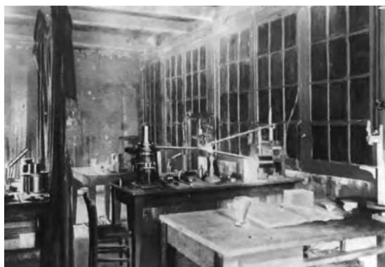
Fig. 4 El "Laboratorio Curie": a la izquierda, banco de química, derecha, cámara de ionización y electrómetro
