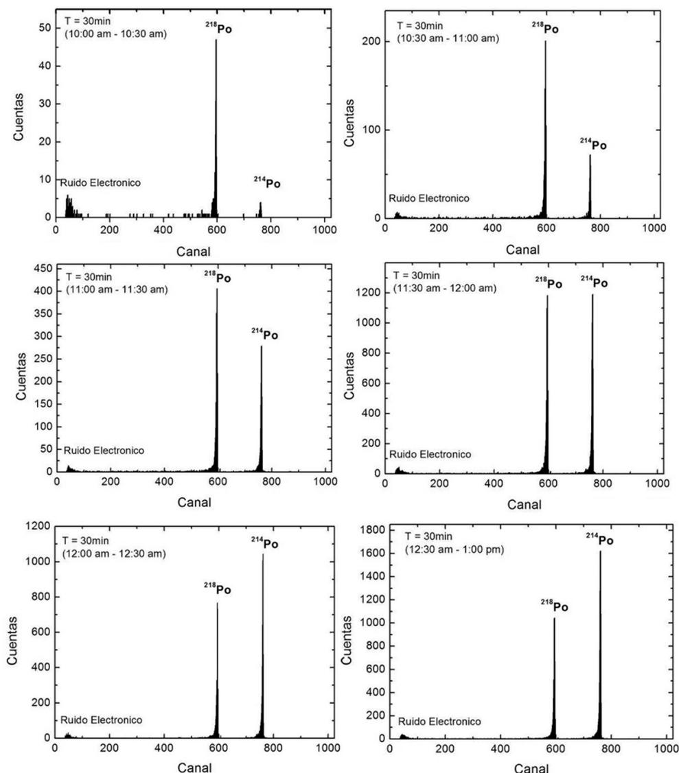
Fig. 6. Espectro típico de las partículas alfa medidas con el prototipo desarrollado que son producidas por los productos de la desintegración del Radón en función del tiempo tomadas cada 30 min.
