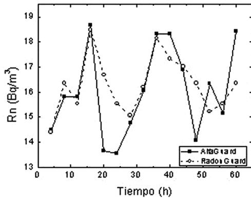
Fig. 8. Monitoreo de radón durante dos días y medio en el ambiente ventilado B usando el equipo AlfaGuard y el prototipo RadonGuard.
