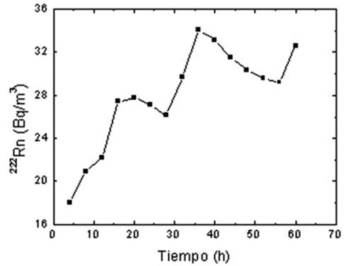
Fig. 10. Monitoreo de radón durante un día en un ambiente ventilado usando nuestro prototipo RadonGuard.
