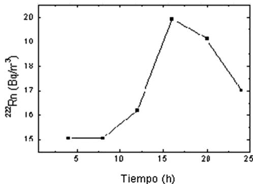
Fig. 9. Monitoreo de radón durante un día en un ambiente ventilado usando nuestro prototipo RadonGuard.
