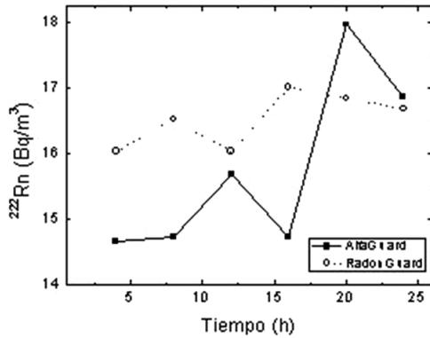
Fig. 7. Monitoreo de radón durante un día en el ambiente ventilado A usando el equipo AlfaGuard y el prototipo RadonGuard.
