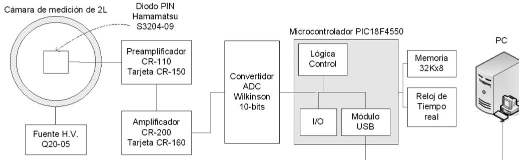
Fig. 2. Diagrama de bloques general del prototipo RadonGuard desarrollado.
