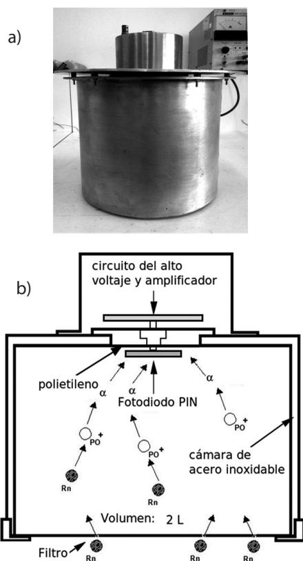
Fig. 3 (a) Diagrama de la cámara de medición. (b) Primer plano lateral del blindaje. Se observa la ranura de 4 mm para el ingreso de aire al interior de la cámara de medición.
