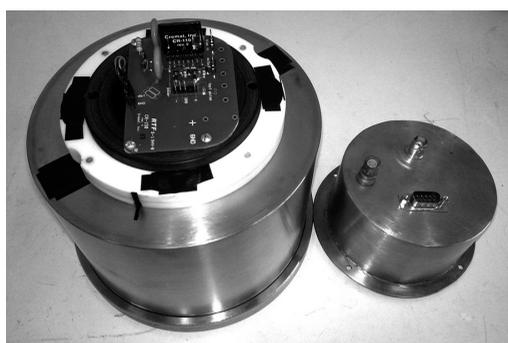
Fig. 4. Fotografía del módulo preamplificador CR-110 y tarjeta de montaje CR-150 instalados en el soporte de polietileno sobre la cámara de medición.
