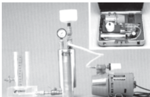
Fig. N.º 2. Equipo de aeración.
