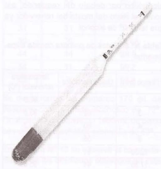
**Figura N°6.** Alcoholímetro de vidrio
