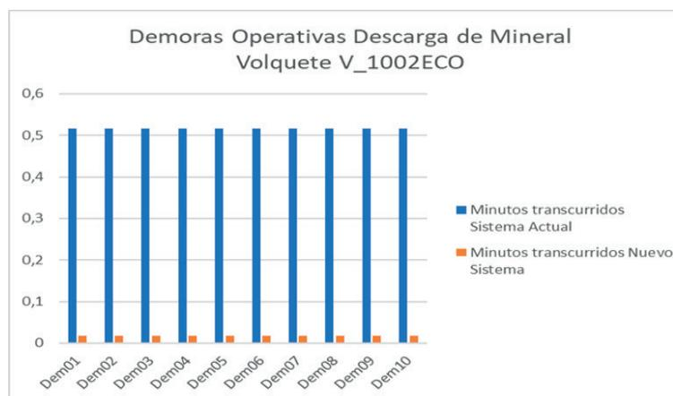
**Fig. 27.** Tiempos de demora operativa en cola de descarga del sistema actual y demo del nuevo sistema.
