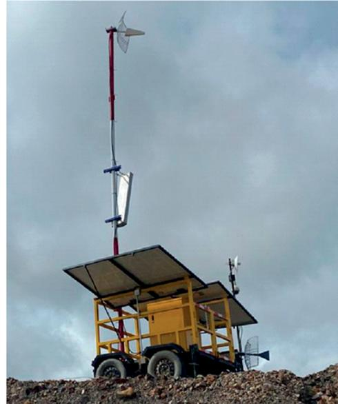
**Fig. 17.** Carritos móviles repetidoras el Tajo.
