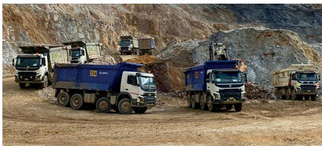
**Fig. 8.** Demora operativa de espera en cola de carga.
