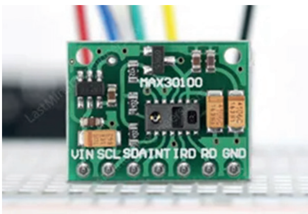
Figura 4 Interfaz del oxímetro de pulso MAX30100 y sensor de ritmo cardíaco
