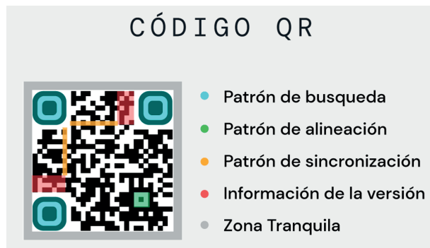
Figura 2 Estructura de código QR.
