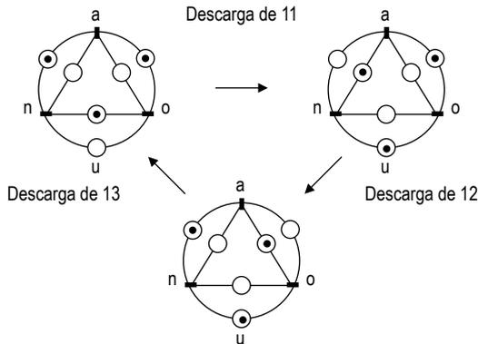
Figura N.º 5. El marcado M' es alcanzable desde M, descargando primero T1 y luego T2.
