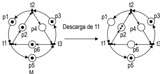
Figura N.º 7. El marcado M no es seguro. Después de descargar T1, P2 tiene 2 elementos.
