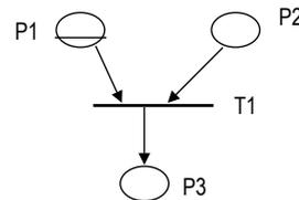
Figura N.º 12. Representación de una cola en una red de Petri.
