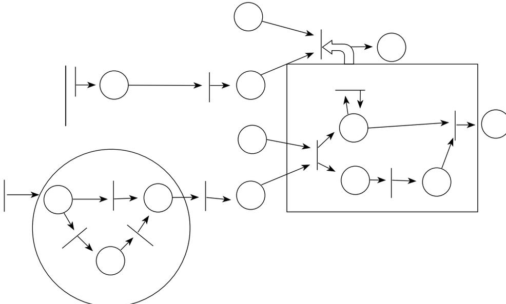
Figura N.º 9. Modelación jerárquica en una red de Petri mediante la sustitución de posiciones y transiciones por subredes. (Tomado de Peterson [9]).
