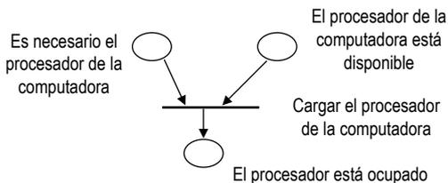
Figura N.º 3. Aparición simultánea de dos condiciones para una transición.
